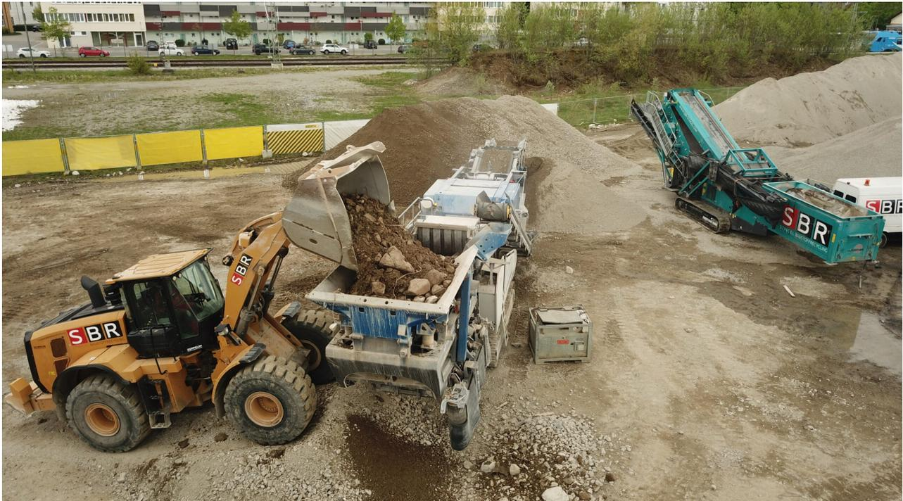
Ein Bagger befüllt den Prallbrecher auf dem unweit gelegenen Zwischenlager. Bild: Georg Reisch GmbH & Co. KG
