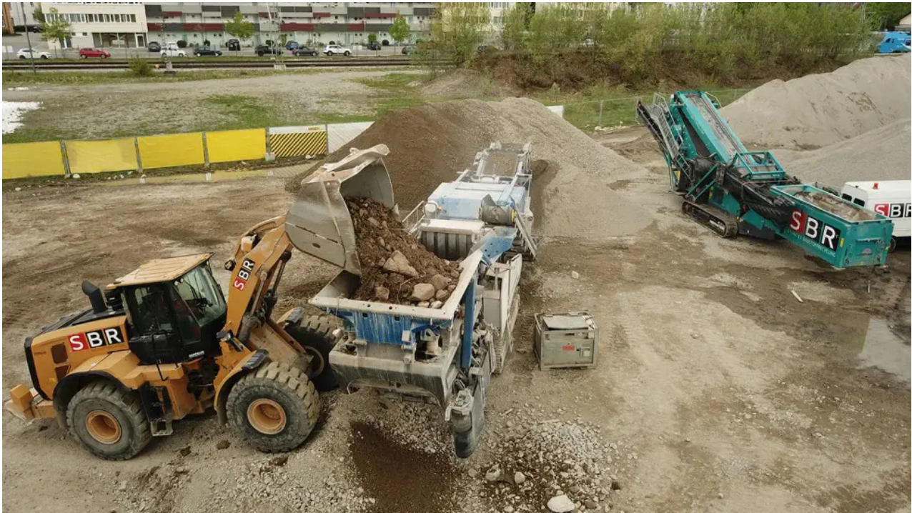
Ein Bagger befüllt den Prallbrecher auf dem unweit gelegenen Zwischenlager. Foto: Reisch
