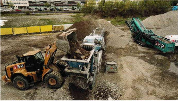
Ein Bagger befüllt den Prallbrecher auf dem unweit gelegenen Zwischenlager. (Foto: Georg Reisch GmbH & Co. KG)
