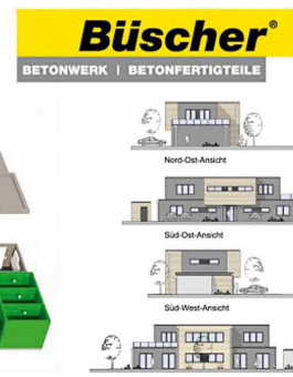
Abb. 5: Das Büscher-Recycling-Haus mit 100 % Natursteinersatz in den R-Betonen für die grün markierten Innenbauteile [© Betonwerk Büscher GmbH & Co. KG]
